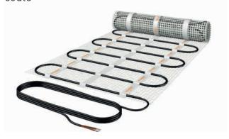
Le chauffage de revêtement routier GSN pour pose dans de l'asphalte coulé permet de protéger les allées de garages, sorties de secours, entrées, etc. contre la neige et la glace. La natte chauffante GSN se compose d'une armature en fibre de verre sur laquelle le câble de chauffage bi-conducteur est collé. La température de stockage autorisée est de 240 °C pendant 35 min.
